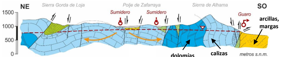
Fig. 4. Corte hidrogeológico de los acuíferos de las sierras Gorda (Granada) y Alhama. Las flechas naranjas señalan la dirección del flujo subterráneo. Línea roja discontinua: nivel piezométrico. Modificado de López-Chicano (1992) y CEHIUMA (2019).
