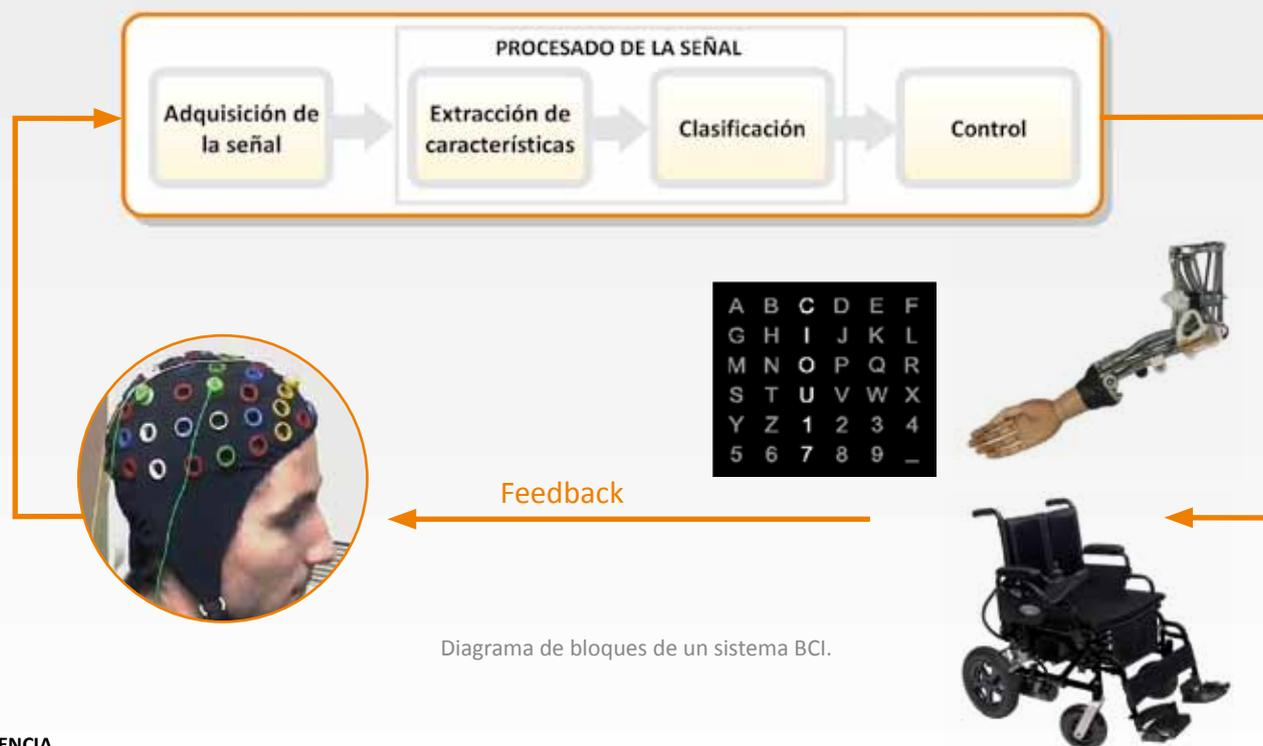
Diagrama de bloques de un sistema BCI.
